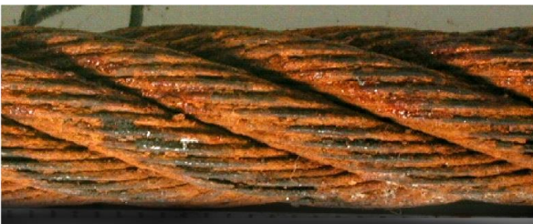
Bild 3: Leitlinie zur Beurteilung und Einstufung äußerlicher Korrosion
