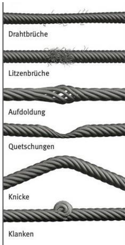
Bild 1: Seilbeschädigungen
