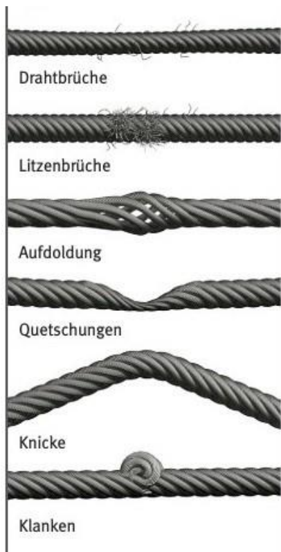
Figure 1 : Types d'endommagement du câble
